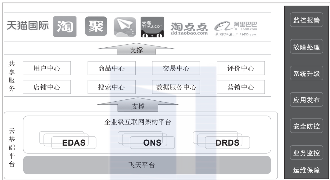
图 2-6 淘宝基于阿里云平台的架构
